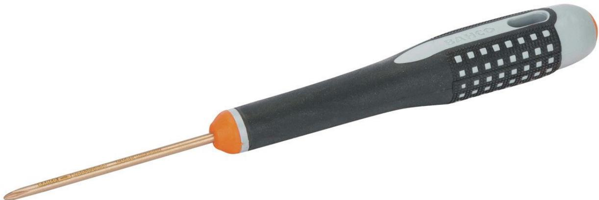
Funkenfreie Werkzeuge werden in Bereichen eingesetzt, in denen durch Funkenflug eine potenzielle Feuer- und Explosionsgefahr besteht. ERGO™ Phillips-Schraubendreher aus Kupferberyllium, PH0 x 50 .
