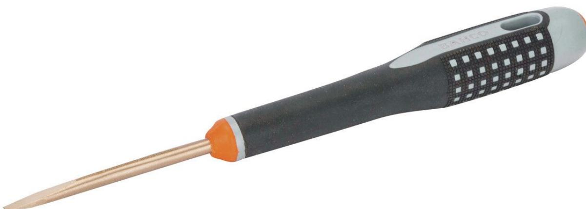
Funkenfreie Werkzeuge werden in Bereichen eingesetzt, in denen durch Funkenflug eine potenzielle Feuer- und Explosionsgefahr besteht. ERGO™ Schraubendreher aus Kupferberyllium für Schlitzschrauben, funkenfrei, 0,4 x 3 x 50 .
