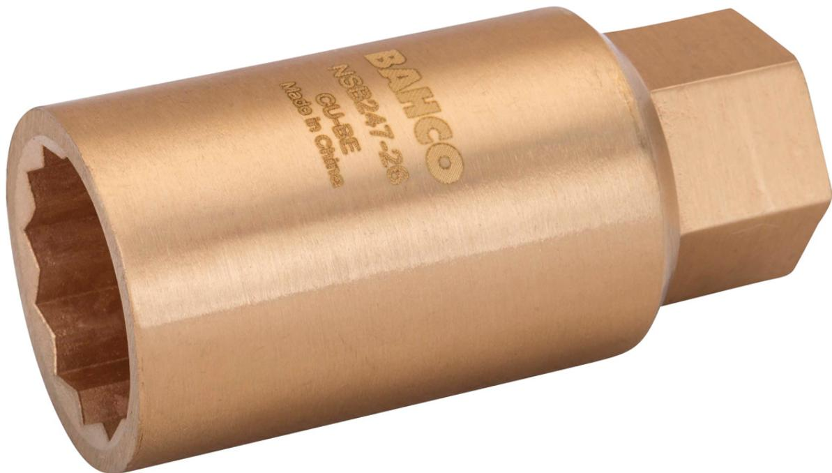
Funkenfreie Werkzeuge werden in Bereichen eingesetzt, in denen durch Funkenflug eine potenzielle Feuer- und Explosionsgefahr besteht. 1/2"-Zündkerzen-Steckschlüssel-Einsatz aus Kupferberyllium mit Sechskantprofil.
