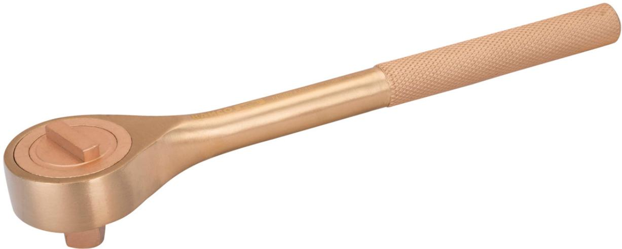
Funkenfreie Werkzeuge werden in Bereichen eingesetzt, in denen durch Funkenflug eine potenzielle Feuer- und Explosionsgefahr besteht. 3/4-Umschaltknarre aus Kupferberyllium, funkenfrei, 320 mm.
