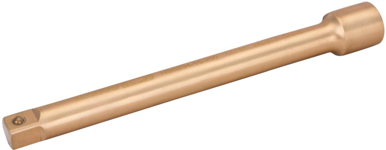
Funkenfreie Werkzeuge werden in Bereichen eingesetzt, in denen durch Funkenflug eine potenzielle Feuer- und Explosionsgefahr besteht. Funkenfreie 1"-Verlängerung aus Kupferberyllium, 250 mm.
