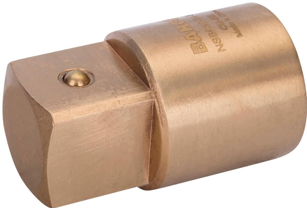
Funkenfreie Werkzeuge werden in Bereichen eingesetzt, in denen durch Funkenflug eine potenzielle Feuer- und Explosionsgefahr besteht. 1- bis 3/4-Adapter aus Kupferberyllium, mit Vierkantantrieb.
