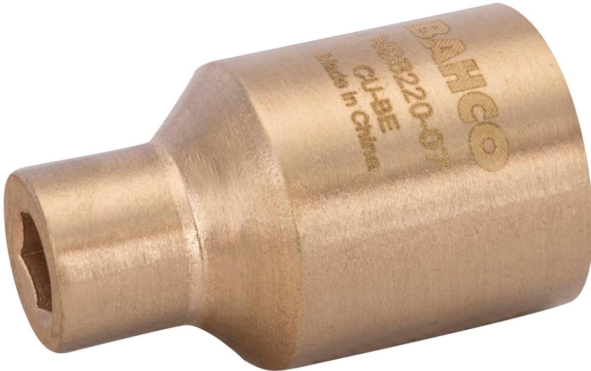
Funkenfreie Werkzeuge werden in Bereichen eingesetzt, in denen durch Funkenflug eine potenzielle Feuer- und Explosionsgefahr besteht. 1/2-Steckschlüssel-Einsatz aus Kupferberyllium mit 28-mm-Sechskantprofil, funkenfrei.
