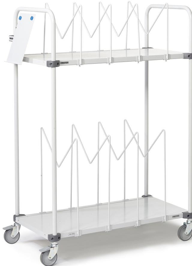
Wagen für Verpackungskartons. Böden mit stufenlos verstellbaren M-Unterteilerbügel. Rahmen und individuell höhenverstellbare Böden aus epoxidpulver beschichtetem Stahl. Höhe der großen Unterteilerbügel 540 mm, niedrigster Punkt 330 mm über dem unteren Bord, Höhe der kleinen Unterteilerbügel 315 mm, niedrigster Punkt 105 mm über dem oberen Bord. Vier Lenkrollen (Ø 100 mm), zwei davon mit Bremse.
