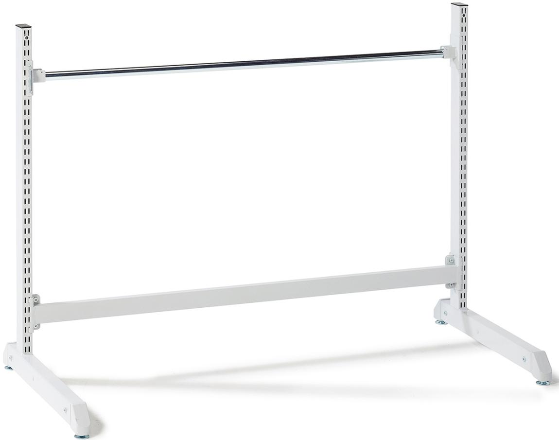
Niedriger Ständer für eine Rolle. Die Rolle ist höhenverstellbar. Achsdurchmesser 25 mm. Max Ø Rolle 800 mm. Kann durch ein zusätzliches Rollenhalter-Set, Rollensatz und Schneidevorrichtung PPC erweitert werden. Max. Tragfähigkeit 40 kg pro Rolle.
