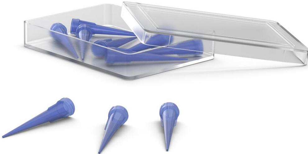
In der Produktpalette von JBC finden sich verschiedene Ausführungen von Dosiernadeln und konischen Spitzen für eine präzise Dosierung verschiedener Medien. Die Dosierspitze ND22P aus Kunststoff wird für Lötpaste Typ 3 empfohlen. Alle Dosiernadeln und Dosierspitzen sind mit dem manuellen Lötpasten-Spender DPM und den dazugehörigen Dosierkartuschen SB03CC und SB05CC kompatibel. Im Lieferumfang ist eine VPE mit 10 Stück Dosierspitzen enthalten.
