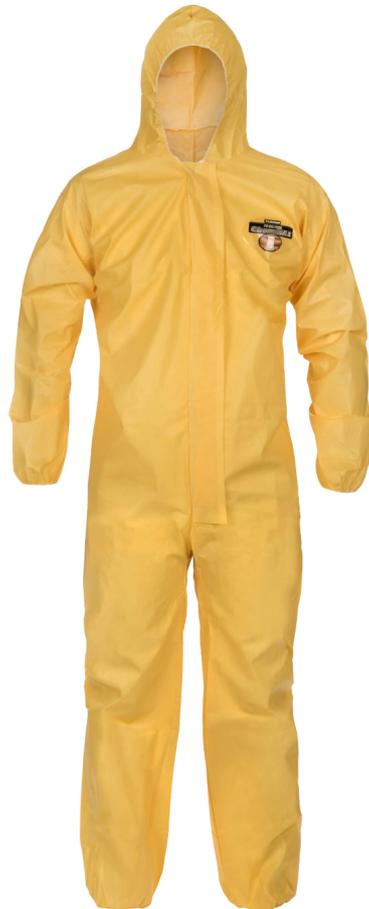
Polymerbeschichteter Chemikalienschutzanzug, Kapuze mit Gesichtsgummi, dichter Maskenabschluss, Gummizug an Arm- und Beinenden, heißüberklebte Nähte, verklebbare, doppelte Reissverschlussabdeckung, leichtes, weiches und dehnbares sowie geräuscharmes Material, gepolsterte, doppellagige Knieschützer für mehr Komfort, Schutz vor zahlreichen anorganischen Chemikalien und biologische Gefahrstoffe, innenseitig antistatisch
