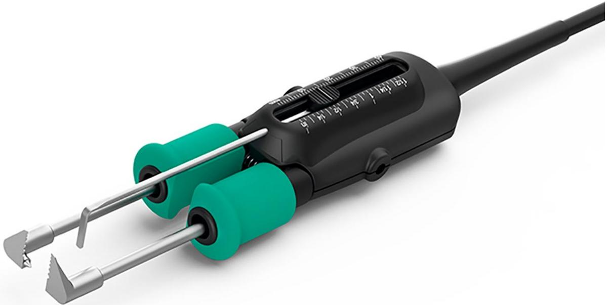
Die WS440 ist speziell für das Abisolieren von Hochtemperaturkabeln aus thermostabilen Materialien wie Teflon\*, Kapton\*, Silikonkautschuk usw. von 34 bis 16 AWG (0,16 bis 1,29 mm) bei Temperaturen bis zu 800 °C / 1470 °F ausgelegt.
