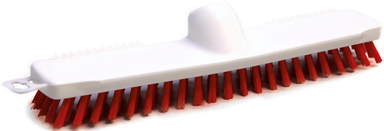
Der Schrubber besteht aus kurzen, harten Fasern, die haftenden und groben Schmutz entfernen. Der Schrubber ist universell einsetzbar. Besonderheit des kleinen Schrubbers: spezielle Vorkante kann als Wasserschieber benutzt werden, und hat zusätzlich eine gezackte Kante zum Entfernen von hartnäckigem Schmutz. Fasersträrke ,5 mm universell einsetzbar genormtes Gewinde (deutsche Norm für die Stielgewinde) temperaturbeständig bis 13Â° C zwei Größen: für große und kleine Flächen mit Aufhänger
