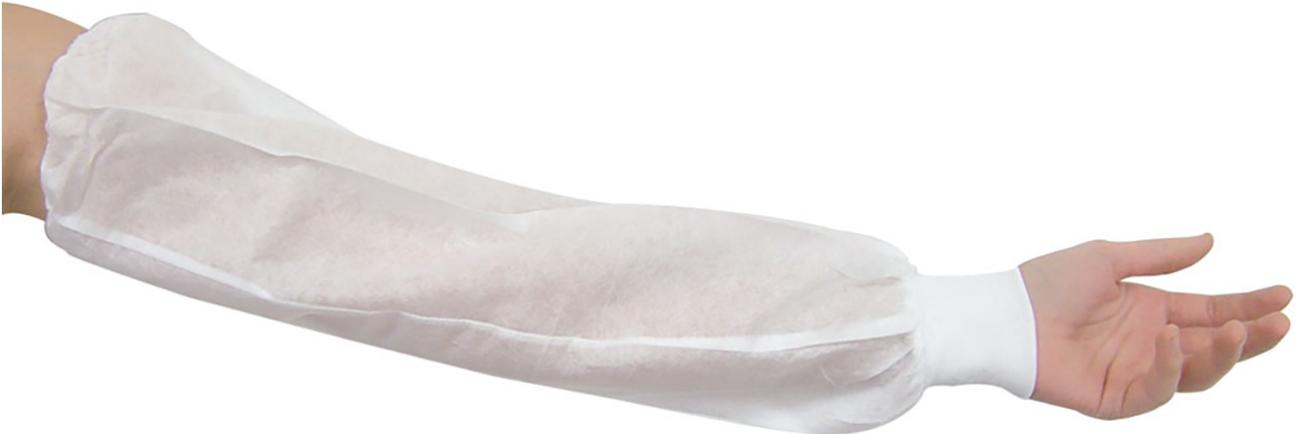
Der Schutzärmel ist aus SMS, einem dreilagigen Material, bei dem zwei Lagen Polypropylen- Vlies eine Lage Meltblown umgeben. Dieser Schutzärmel ist atmungsaktiv und feuchtigkeitsundurchlässig. Zudem verfügt er über einen weichen und angenehmen Strickbund. Vor allem in der Lebensmittelindustrie ist der Schutzärmel SMS verwendbar.
