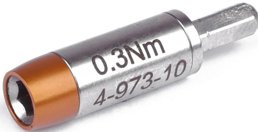
voreingestellter Drehmoment, Genauigkeit Toleranz +/-10%. präzise und genau, für 20.000 Klicks. In Verbindung mit Elektrowerkzeug max. Drehzahl 100 U/min.
