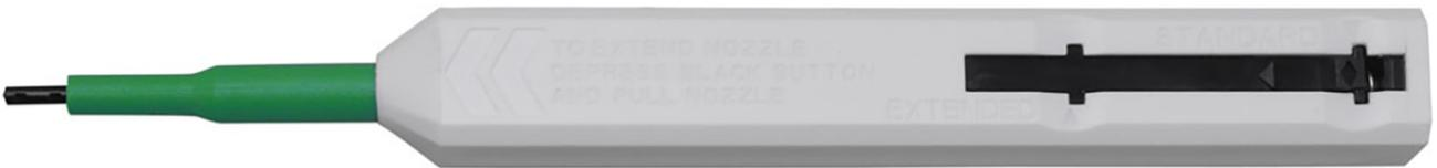
Dieses Instrument reinigt die Endflächen der Klemmhülse von Staub, Öl und anderen Verschmutzungen, ohne die Endfläche zu beschädigen oder zu zerkratzen. Die reinigenden Mikrofasern sind dicht verseilt und die rückstandsfrei verlängerbare Spitze erreicht vertiefte Anschlüsse. Beim Drücken dreht sich die, auf den Anschluss gesetzte, Spitze um 180 Grad und führt eine Reinigungsbewegung aus, mit einem akustischen Klick Geräusch.
