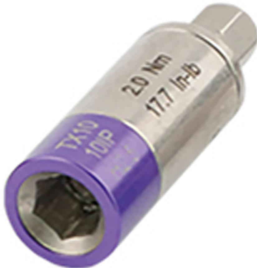
Der Drehmomentwert ist im Adapter voreingestellt und kann zwischen jedem handelsüblichen Haltewerkzeug und einem 1/4 Zoll Bit gespannt werden. So wird aus jedem Bit-Halter ein Drehmoment-Schraubendreher.
