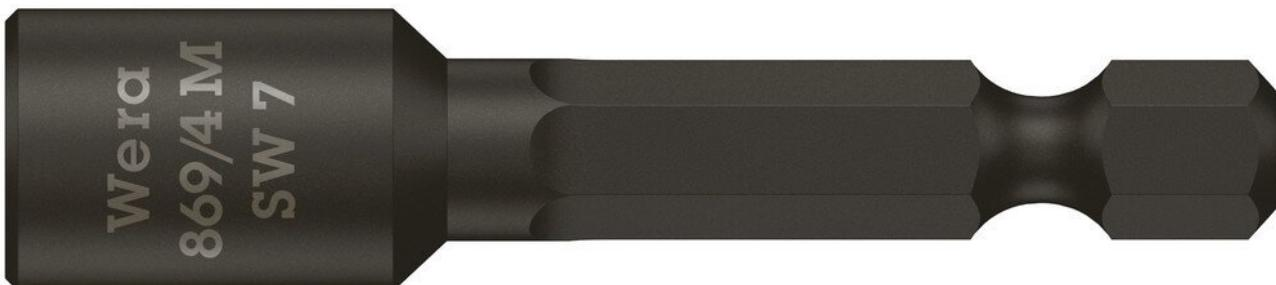
Metrischer Steckschlüsselleinsatz für Außensechskantschrauben. Mit starkem Dauermagnet. 1/4"-Sechskant, passend für Halter nach DIN ISO 1173-F 6,3.
