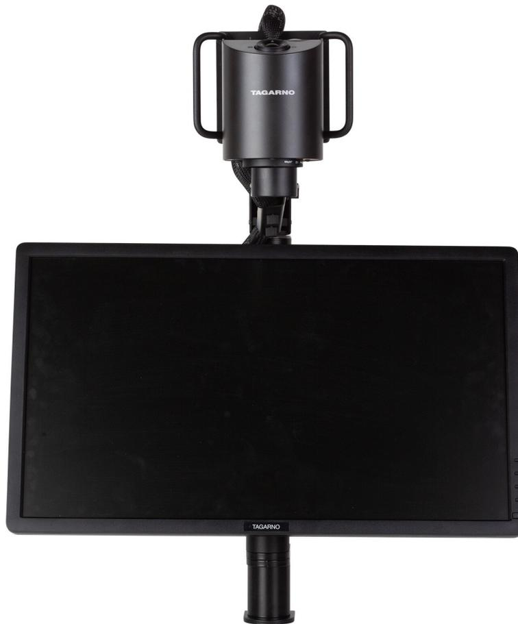
ZAP INLINE von TAGARNO beeindruckt mit einem 30-fachen optischen Zoom, einer ultrahohen Bildrate von 60 fps und seinem Laserpointer. ZAP INLINE ist mit einem +2 Objektiv ausgestattet, das ein großes Sichtfeld gewährleistet. Damit eignet sich ZAP INLINE perfekt für die Inspektion größerer Proben oder Prozesse, bei denen ein geringer Vergrößerungsbereich ausreicht.
