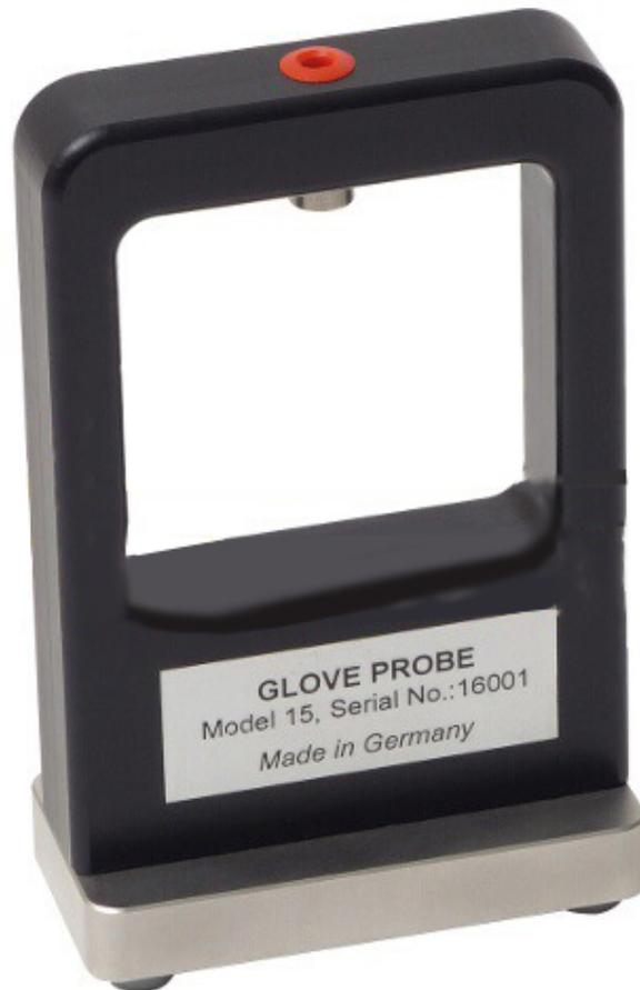
Die Handschuh Elektrode von Warmbier dient zur Messung des Ableitwiderstandes von Handschuhen und Fingerlingen im getragenen Zustand gemäß ANSI/ESD SP15.1
