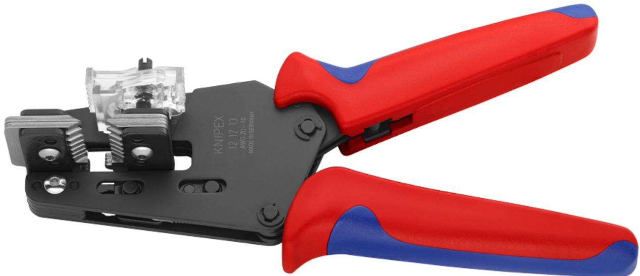
Formschlüssiges Abisolieren auch von schwer zu entfernenden Isolierwerkstoffen aus PTFE, Silikon, Radox®, Kapton® und Gummi; auch mehrlagig. Ein zweites Messerpaar hält die verbleibende Isolierung zuverlässig fest. Genau auf den jeweiligen Leiterquerschnitt abgestimmte, auswechselbare Formmesser. Mit einstellbarem Längenanschlag für gleiche Abisolierlängen bei Serienarbeit. Speziell für Kabel gemäß amerikanischer Spezifikation (AWG). - AWG: 10 / 12 / 14 / 16 / 18 / 20
