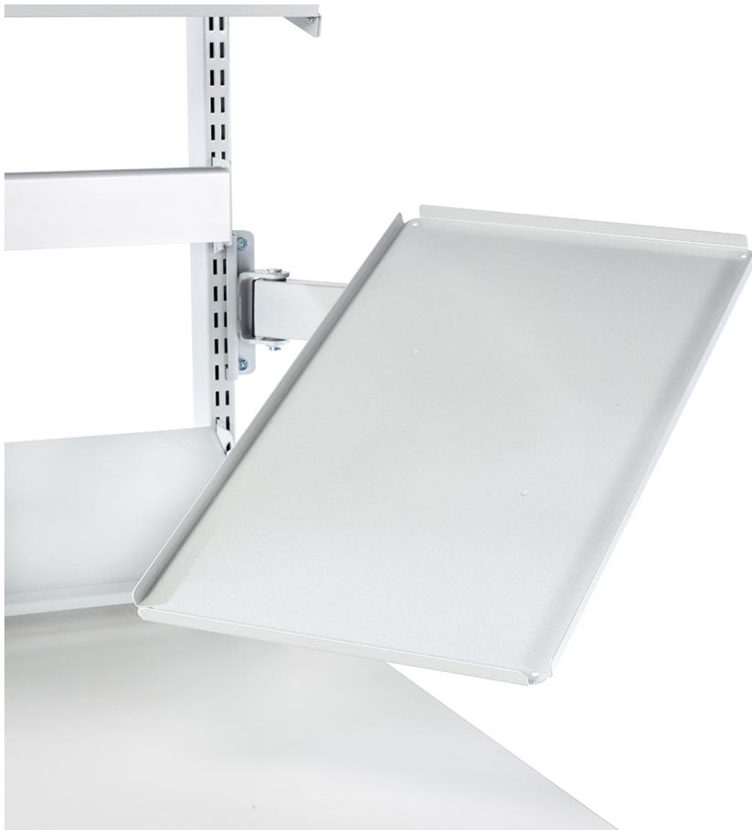
Dreh- und neigbare Ablage mit Doppelarm (0-25°) mit ESD-Matte. Gebogene Kante von 15 mm. Max. Tragfähigkeit 15 kg.
