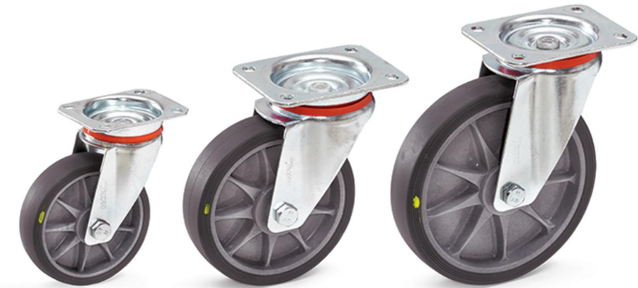
Gehäuse Stahlblech verzinkt. Räder mit TPE-ESD-Bereifung (thermoplastisches Elastomer elektrisch leitfähig). Naben mit Präzisions-Rillenkugellager. Reifen nicht kreidend (spurlos).
