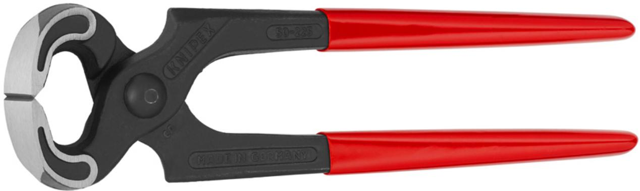
Für härteste Beanspruchung. Bei Handwerkern wegen der präzisen Verarbeitung beliebt. Hohe Verschleißfestigkeit und ausgewogene Gewichtsverteilung. Schneidhärte ca. 60 HRC. - Schneidwerte mittelharter Draht (Durchmesser): Ø 1,8mm - Schneidenlänge mm: 20,5mm
