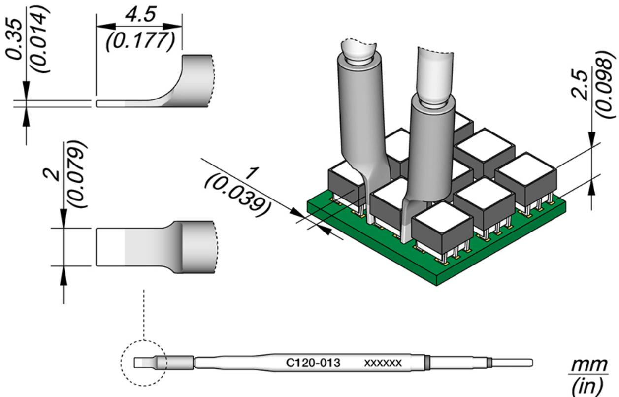
Die Lötspitzen der Serie C120 sind für PA120 Mikro-Pinzetten geeignet. Diese können zum Löten und Entlöten von Chip-Komponenten oder Dual-in-Line verwendet werden. Die Spitzen werden einzeln verkauft.
