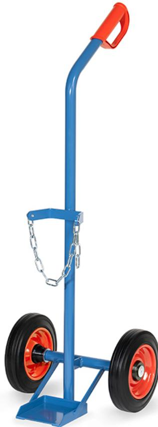
Stahlflaschenkarre aus Stahlrohr geschweißt, pulverbeschichtet blau RAL 5007. Flaschenhalterungen mit Kettensicherung. Räder mit Vollgummibereifung, Naben mit Rollenlager.
