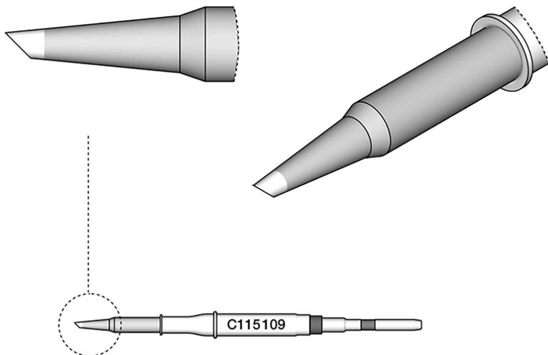
Die Lötspitzen der Serie C115 eignen sich zum Löten und Reparieren sehr kleiner Bauteile. Diese sind kompatibel mit NT115-A, NP115-A und AN115-A Nano Löthandstücken.
