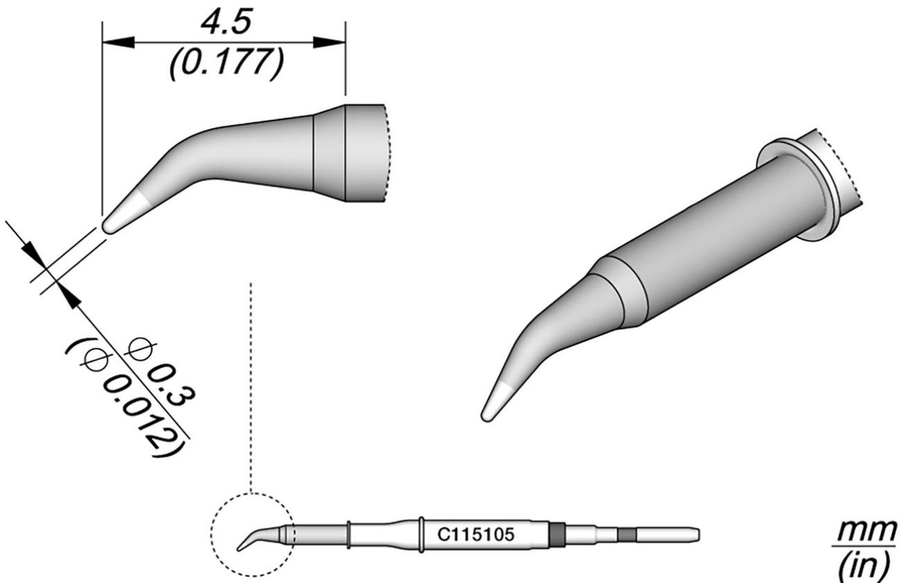
Die Lötspitzen der Serie C115 eignen sich zum Löten und Reparieren sehr kleiner Bauteile. Diese sind kompatibel mit NT115-A, NP115-A und AN115-A Nano Lötstücken.
