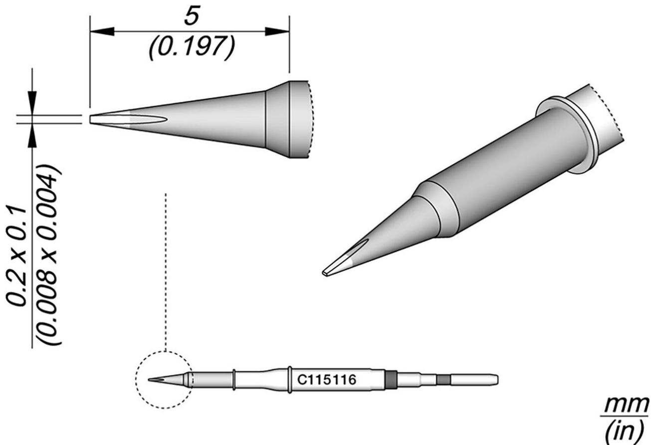
Die Lötspitzen der Serie C115 eignen sich zum Löten und Reparieren sehr kleiner Bauteile. Diese sind kompatibel mit NT115-A, NP115-A und AN115-A Nano Löthandstücken.
