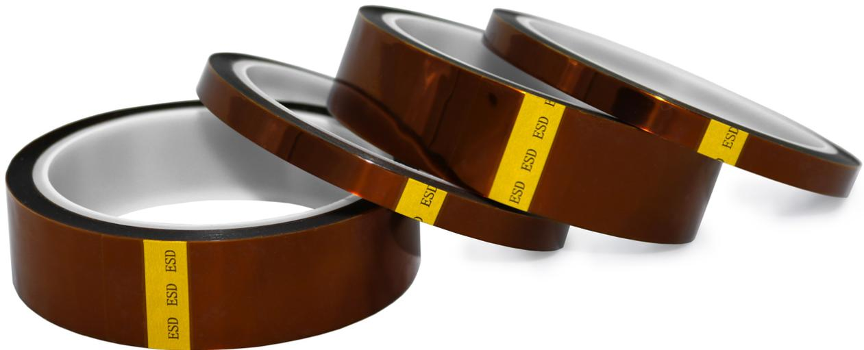
Das Polyimid-Klebeband ist hochtemperaturbeständig und dient als Abdeckband zum Schutz von Kontaktflächen auf Leiterplatten während des Wellenlötprozesses.
