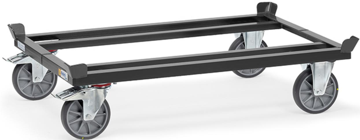
Für Flachpaletten und Gitterboxen. Robuste Winkelstahl-Schweißkonstruktion, mit 4 Fangecken, pulverbeschichtet, schiefergrau RAL 7015. 2 Lenk- und 2 Bockrollen, TPE-ESD-Bereifung, Naben mit Rillenkugellager, Feststeller an den Lenkrollen, gemäß der europäischen Norm EN 1757-3 (Sicherheit von Plattformwagen). Sehr geringer Anfahr-, Roll- und Schwenkwiderstand. Geräuscharmer Lauf auf ebenen Böden. Reifen nicht kreidend (spurlos).
