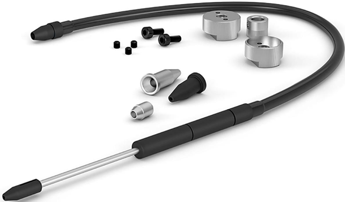
Das Führungs-Kit GSFR ist für die Verwendung mit dem Lotzuführengerät SFR in automatischen Lötprozessen vorgesehen. Das Führungsset kann leicht ausgetauscht werden, wenn andere Lötdrahtdurchmesser verwendet werden. Führungssätze sind auch mit Lötdrahtperforation und für andere Drahtdurchmesser erhältlich. Für den Fall, dass die SFR nicht am Roboterlöt Kopf befestigt ist, sind verschiedene Führungslängen erhältlich, siehe Handbuch für detaillierte Informationen.
