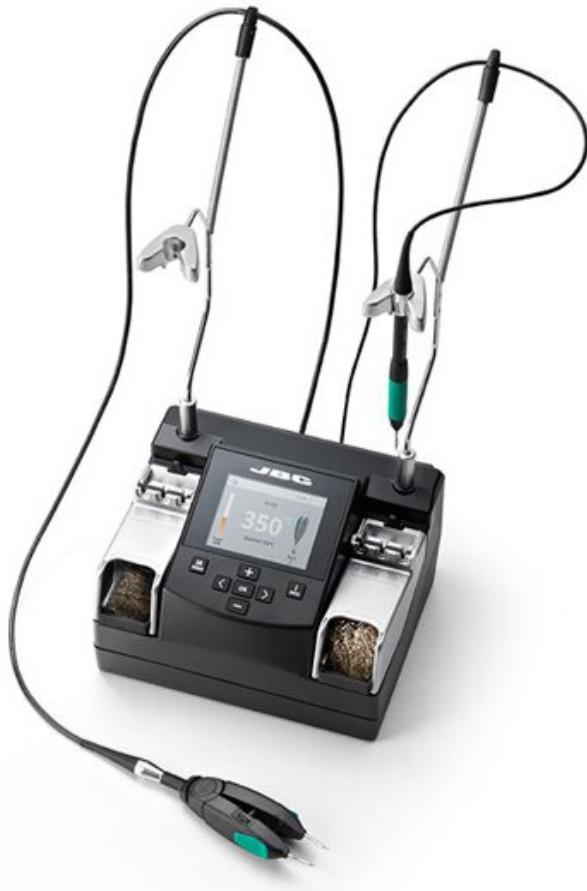
Die JBC NASE-2C Nano-Lötstation ist eine hochpräzise Löt- und Entlötstation aus der JBC Premium Line, die speziell für das Arbeiten an kleinsten SMD-Bauteilen wie 0201, 0402 und 01005 entwickelt wurde. Mit ihrer digitalen Temperaturregelung im Bereich von 90 bis 450°C und einer Leistung von 2×14W ermöglicht sie exakte und stabile Lötprozesse, selbst bei empfindlichsten elektronischen Komponenten.
