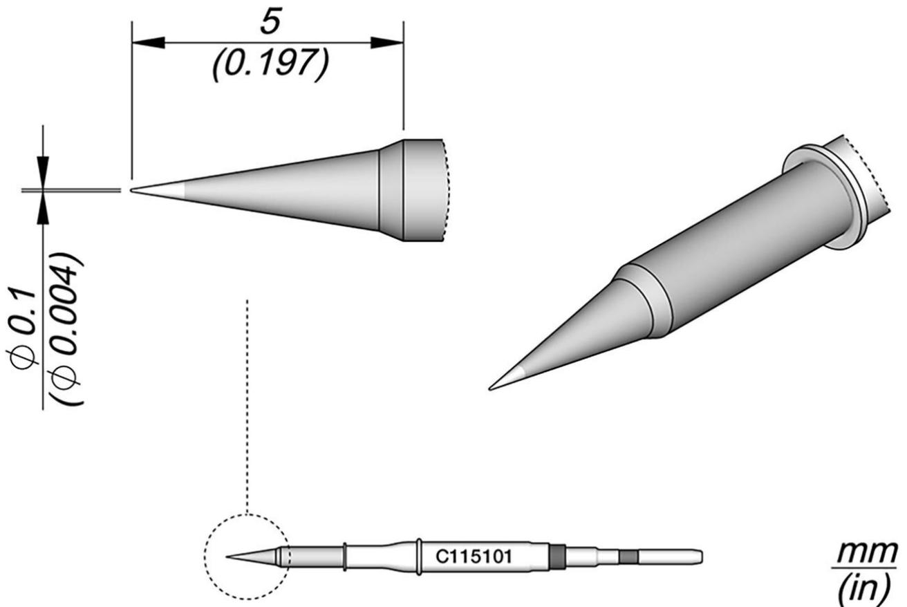
Die Lötspitzen der Serie C115 eignen sich zum Löten und Reparieren sehr kleiner Bauteile. Diese sind kompatibel mit NT115-A, NP115-A und AN115-A Nano Lötstücken.
