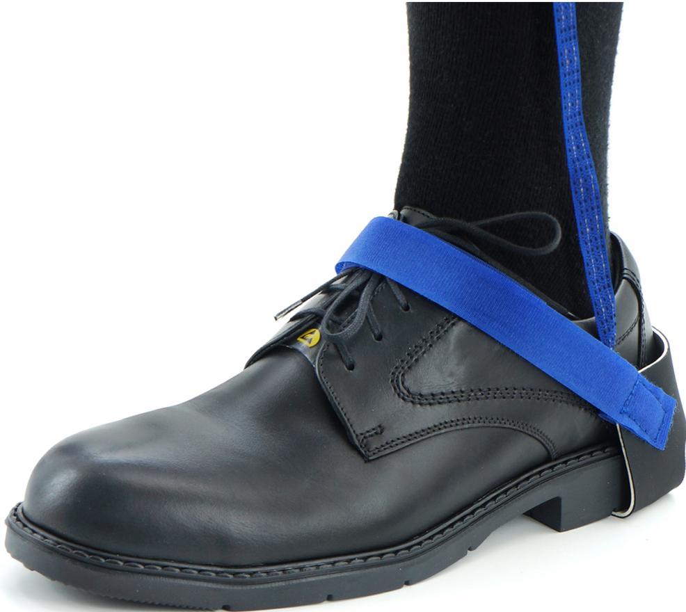
Das ESD-Fersenband von Safeguard ist ein wichtiges Zubehör für die korrekte Personenerdung. Es hat einen Ableitwiderstand von 1 MOhm und einen Klettverschluss. Das Fersenband dient dazu, statische Elektrizität von den Füßen abzuleiten und so Schäden an elektronischen Geräten und Bauteilen zu vermeiden. Der 1 MOhm Ableitwiderstand sorgt dafür, dass die Ableitung der statischen Elektrizität effektiv und sicher erfolgt. Das Band ist schwarz/blau und für Straßenschuhe mit flachen Absatz geeignet.
