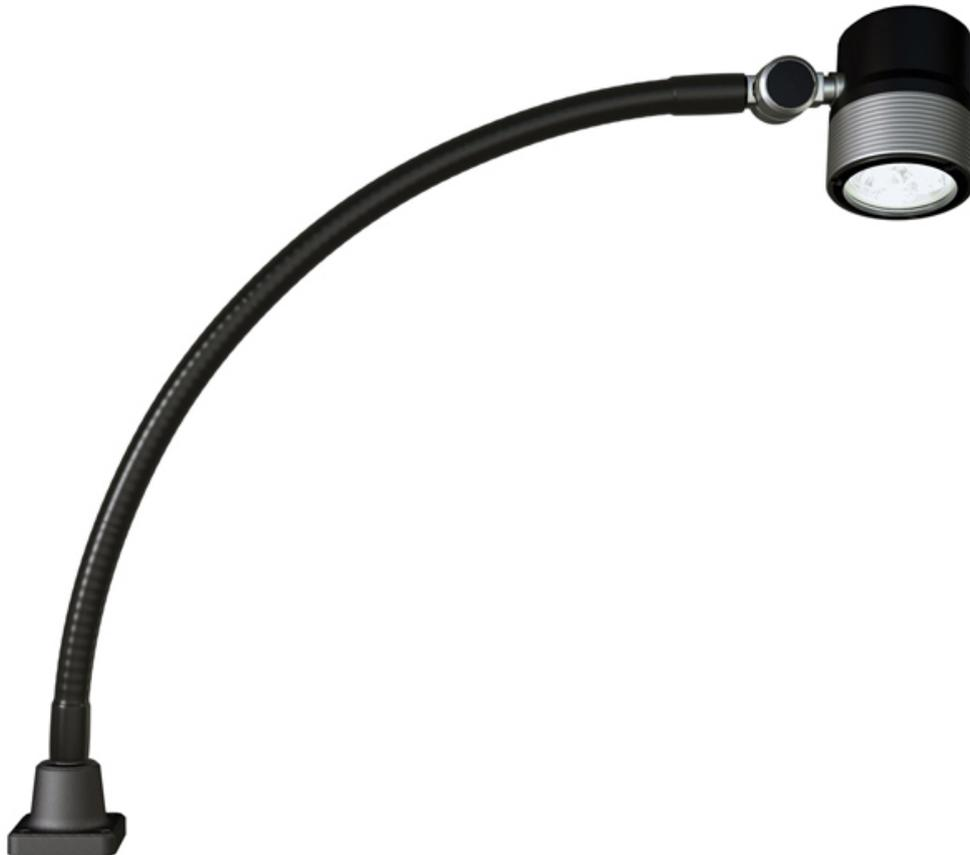
Wartungsfreie LED-Technologie. Starke High Power LEDs für maximales Licht. Mit eng abstrahlender Lichtcharakteristik. Stufenlose und flickerfreie Dimmung (zuschaltbar). Robustes Gehäuse aus Aluminium mit massiver Sicherheitsglasblende. Viton-Dichtung für eine hohe Schutzart. Chemisch beständig gegenüber vielen Medien wie Ölen oder Kühlschmierstoffen. Exakt einstellbarer Flexschlauch. Anschluss an Netzspannung.
