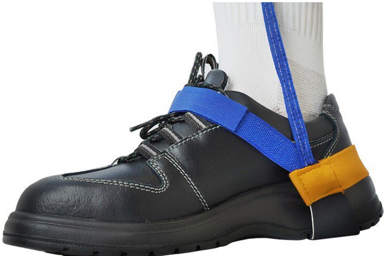
Das ESD-Fersenband von Safeguard ist ein wichtiges Zubehör für die korrekte Personenerdung. Es hat einen Ableitwiderstand von 1 MΩ und einen Klettverschluss. Das Fersenband dient dazu, statische Elektrizität von den Füßen abzuleiten und so Schäden an elektronischen Geräten und Bauteilen zu vermeiden. Der 1 MΩ Ableitwiderstand sorgt dafür, dass die Ableitung der statischen Elektrizität effektiv und sicher erfolgt. Das Band ist blau/gelb und für Straßenschuhe mit flachen Absatz geeignet.
