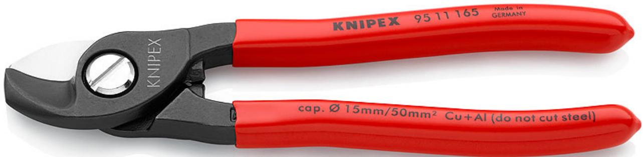
Zum Schneiden von Cu- und Al-Kabeln, ein- und mehrdrähtig. Schneidet glatt und sauber, ohne zu quetschen. Nicht für Stahldraht und hartgezogene Kupferleiter geeignet.
