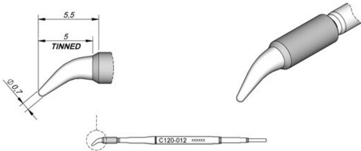
Die Lötspitzen der Serie C120 sind für PA120 Mikro-Pinzetten geeignet. Diese können zum Löten und Entlöten von Chip-Komponenten oder Dual-in-Line verwendet werden. Die Spitzen werden einzeln verkauft.
