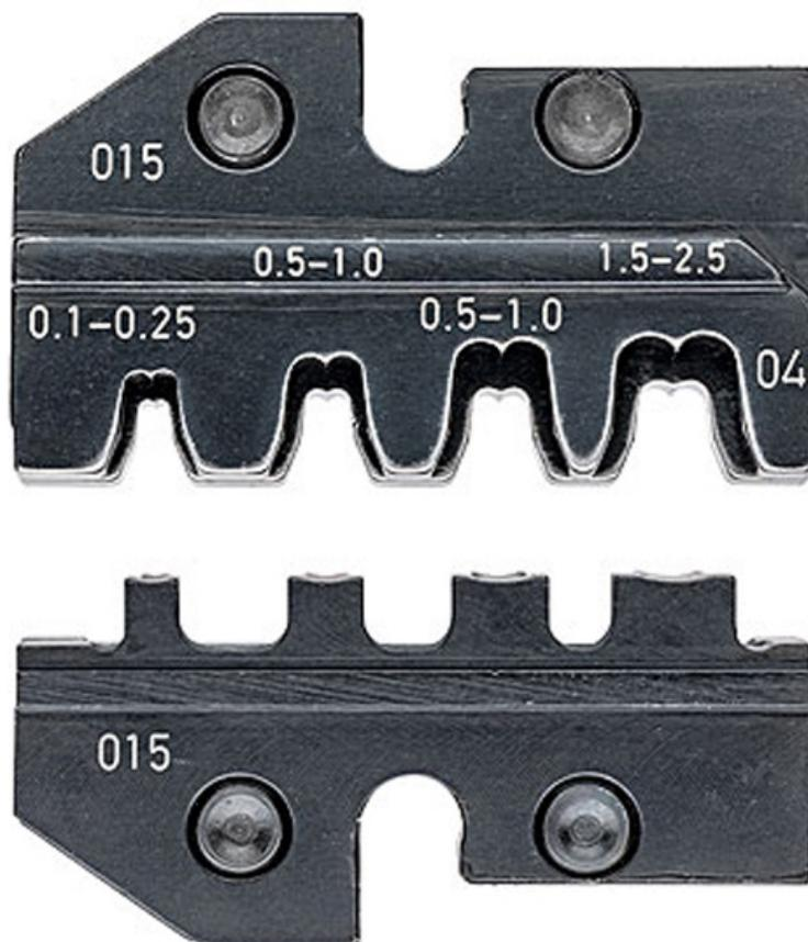
Anwendung: unisolierte, offene Steckverbinder (2,8 + 4,8 mm Steckerbreite) 0,1 - 2,5 mm<sup>2</sup>.
