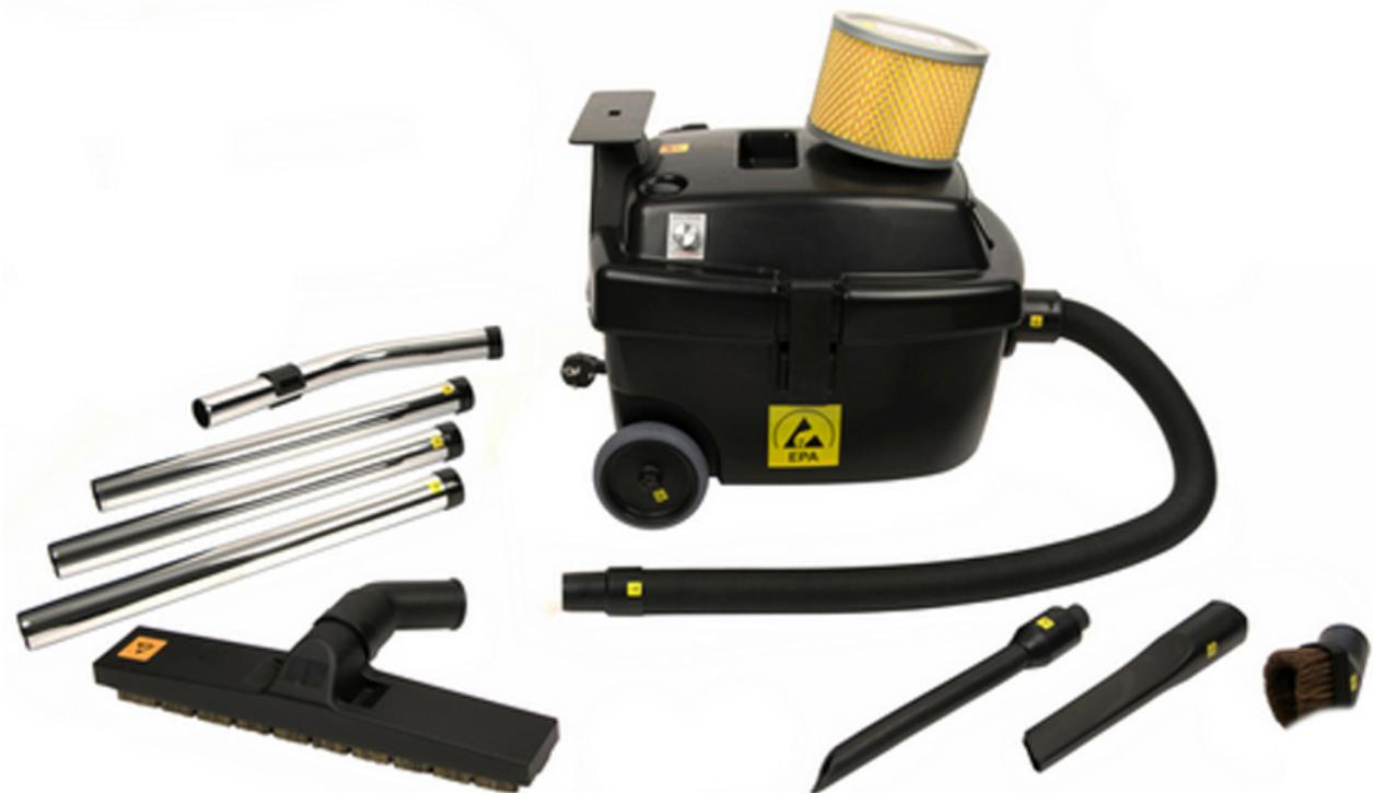
Leitfähiger Boden-Staubsauger mit mikrobakteriellem Control-Filtersystem für den Einsatz in ESD-Schutzzonen (EPA) von höchst empfindlichen Systemen. Mit Blas- und Saugfunktion. Für Reinräume geeignet. Die Saugleistung wird durch einen vollelektronischen Vakuummotor mit Lautstärkeregelung geregelt.
