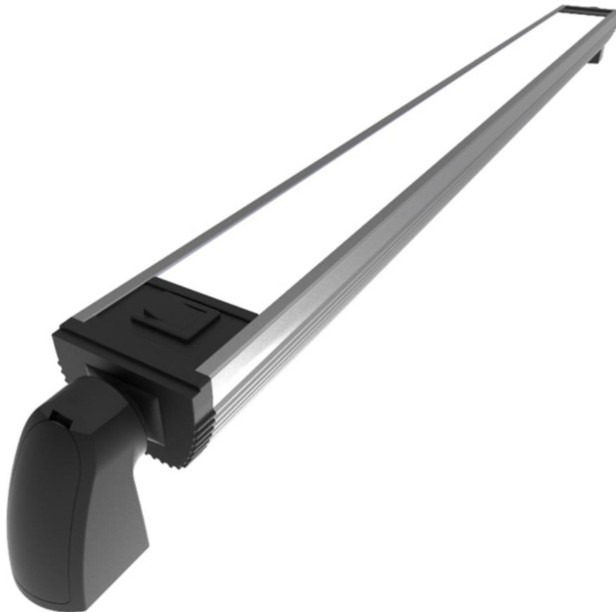
Die Montagemöglichkeiten der PS WorkLED SE Systemleuchten sind kompatibel zu den gängigen Systemprofilen und zu sämtlichen anderen Oberflächen. Die Drehfunktion bei dieser LED Arbeitsplatzleuchte sorgt dafür, dass das Licht auf einen bestimmten Bereich ausgerichtet werden kann. Der Multifunktionstaster ermöglicht dimmen des Lichtes sowie Abspeichern der gewünschten Helligkeitsstufe (Doppelter Tastendruck).
