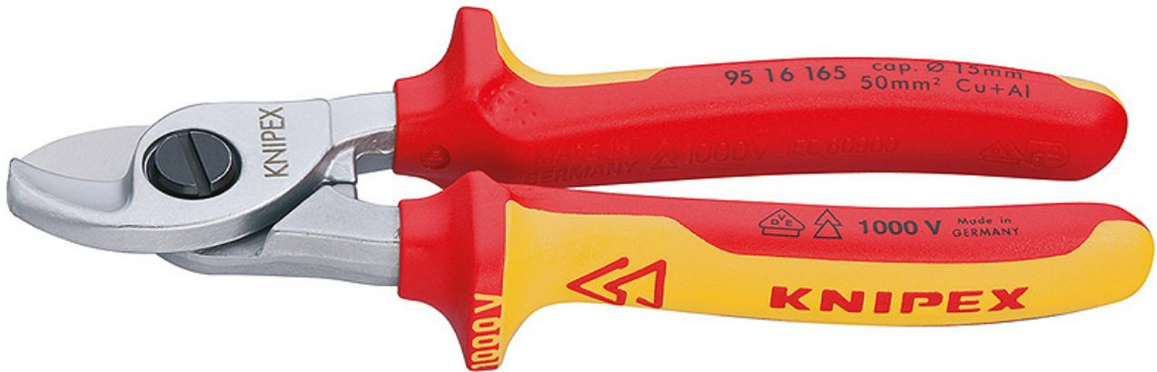
Zum Schneiden von Cu- und Al-Kabeln, ein- und mehrdräftig. Schneidet glatt und sauber, ohne zu quetschen. Nicht für Stahldraht und hartgezogene Kupferleiter geeignet. Gehärtete Schneiden mit Präzisionsschliff. Leichter Schnitt bei Einhandbedienung. Mit Klemmschutz. Nachstellbares Schraubgelenk, selbstsichernd. - Form: 1 - Schneidwert Cu-Kabel, mehrdräftig: 50mm<sup>2</sup> - Schneidwert Cu-Kabel, mehrdräftig: Ø 15mm - AWG: 1/ 0 - VDE-geprüft: Ja
