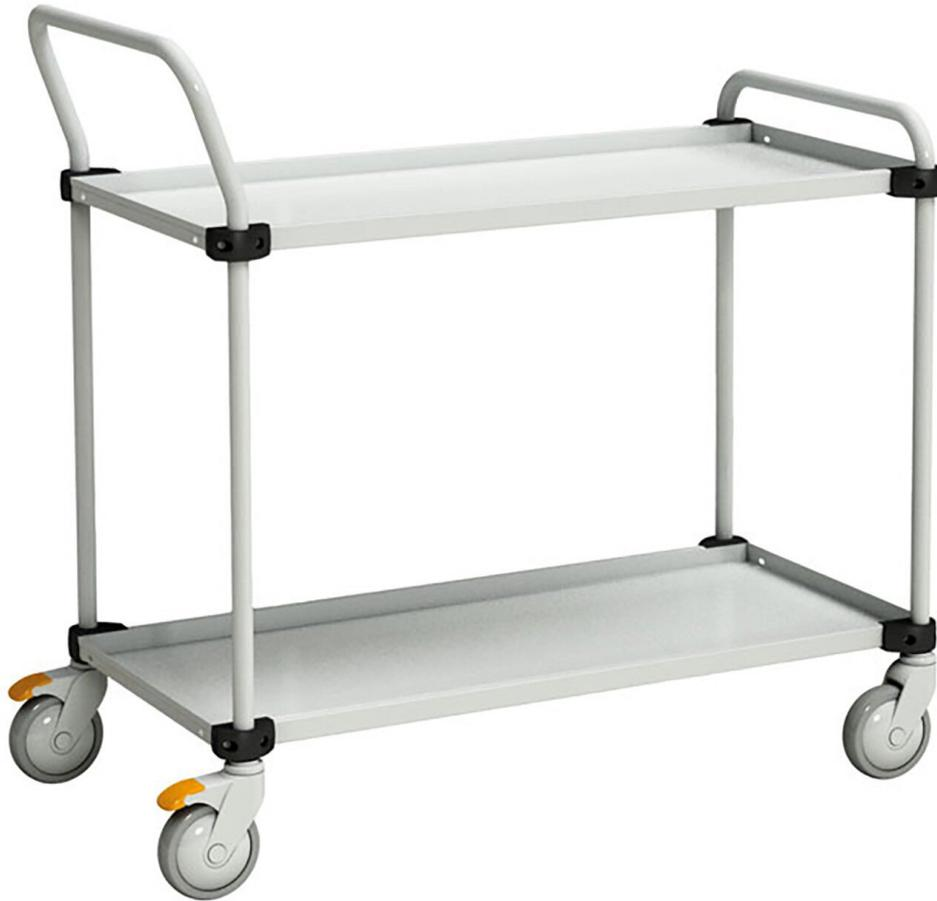
Das Gestell des Wagens besteht aus runden, pulverbeschichteten Stahlrohren (25 mm) und vier Lenkrollen (Ø125 mm), 2 davon mit Bremsen (ESD).
