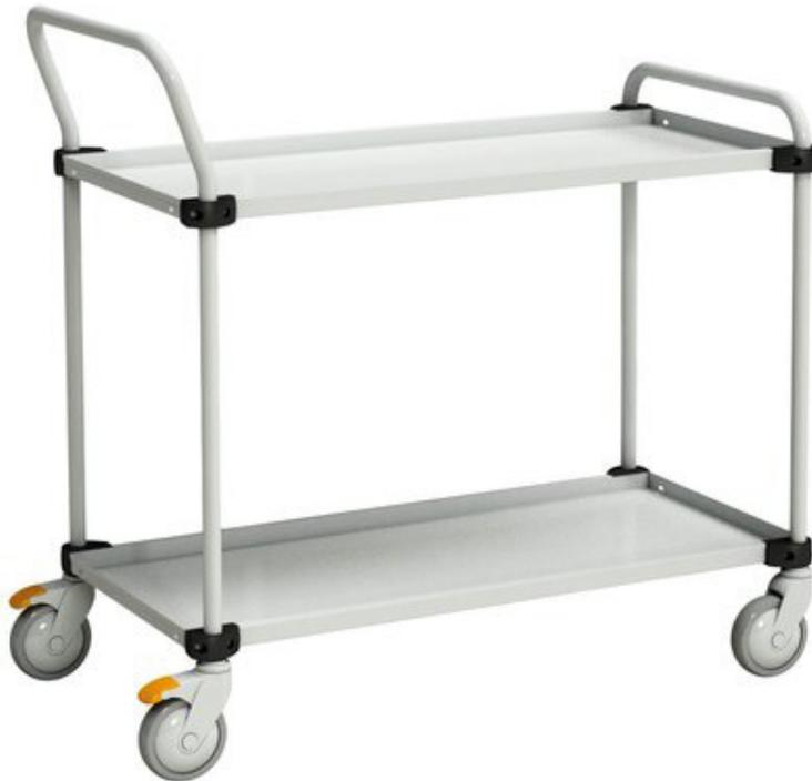
Das Gestell des Wagens besteht aus runden, pulverbeschichteten Stahlrohren (25 mm) und vier Lenkrollen (Ø125 mm), 2 davon mit Bremsen
