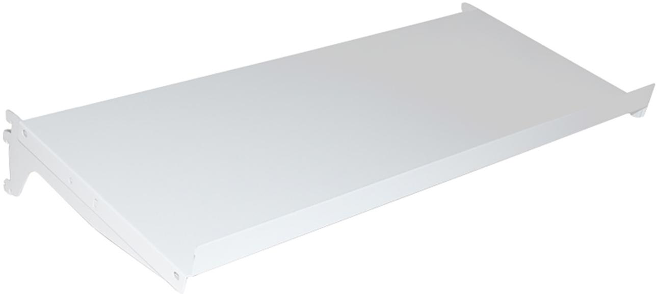
Aufgrund der zweifach verwendbaren Regalhalterungen kann das Regal entweder um 20° geneigt oder in horizontaler Position verwendet werden. Das Regal hat eine integrierte Kante, die je nach Verwendung des Regals entweder vorne oder hinten im Regal eingesetzt werden kann.
