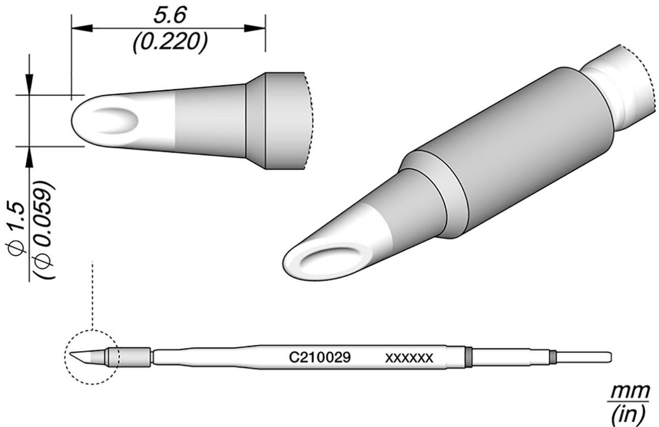
geeignet für SMD, Arbeiten unter dem Mikroskop
