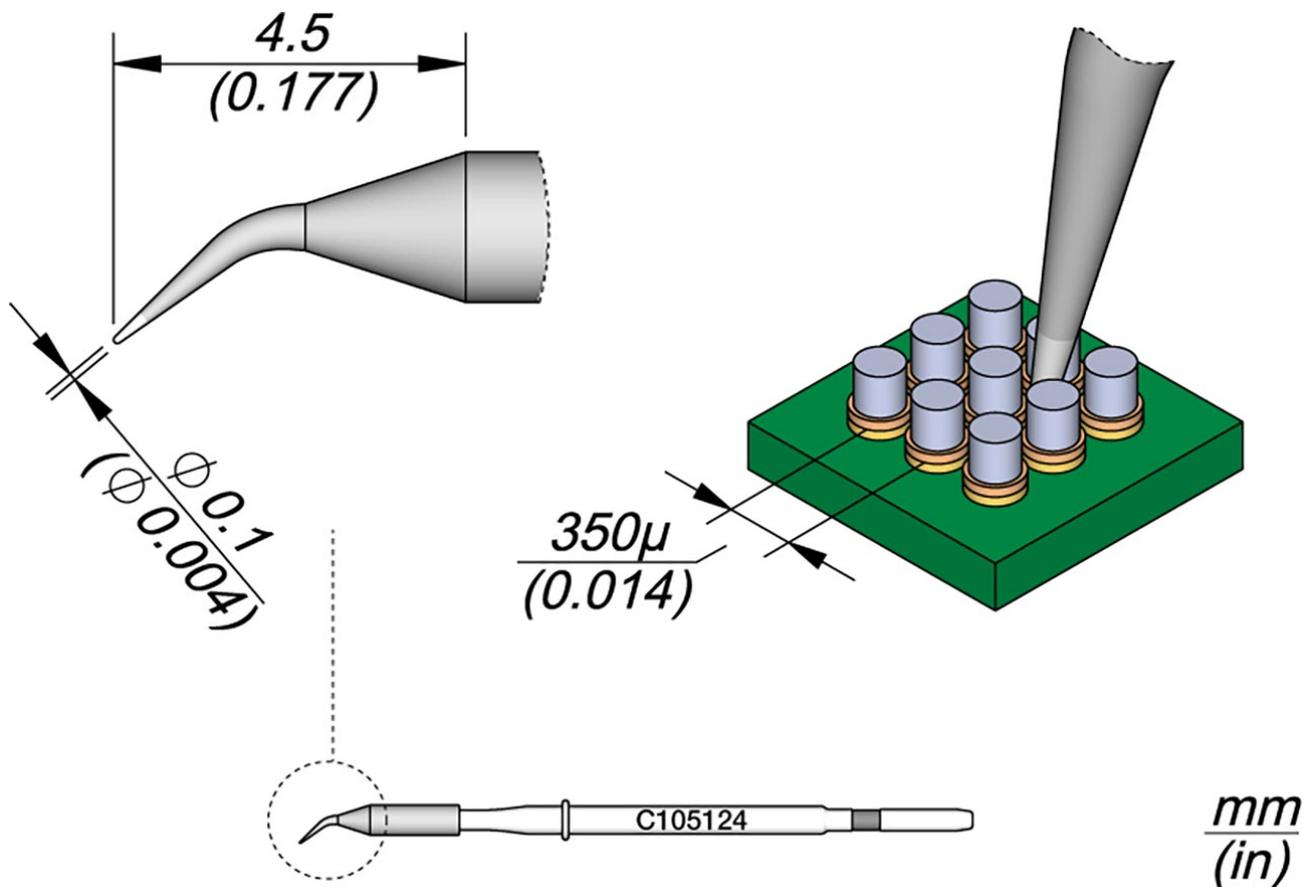
Die Lötspitzen der Serie C105 sind die kleinsten Spitzen der JBC-Serien und eignen sich hervorragend zum Löten und Reparieren sehr kleiner Bauteile. Diese sind kompatibel mit den NT105 und NP105 Nanohandstücken sehr fein, für schwer erreichbare Stellen geeignet
