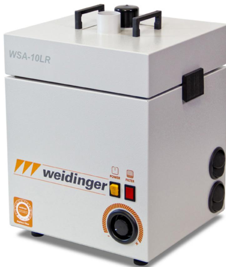
Das Absauggerät WSA-10LR für Lötrauch verfügt über 2 Ansaugstutzen mit einem Außendurchmesser von 50 mm (oben), 4 einstellbare Ausblaskiemer (beidseitig, unten), einer optischen Filteranzeige sowie einem Volumenstromregler.
