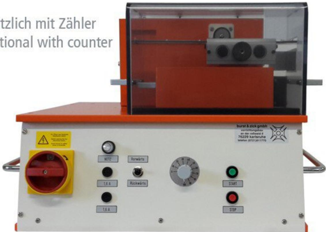
Schneidegerät für radiale Bauteile
